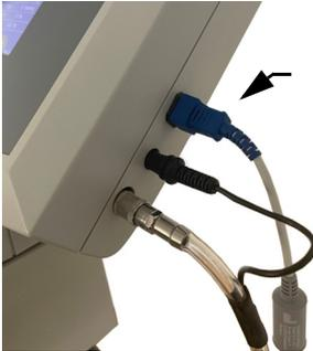
→ Introduzca la clavija del sensor de dedo de SpO<sub>2</sub> (o del sensor de oreja en función de las preferencias del cliente) en la conexión para el sensor de SpO<sub>2</sub>.
