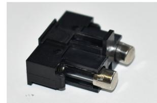
3. Remplacer les deux fusibles. Appuyer sur le porte-fusible jusqu'à ce qu'il s'enclenche et se remette en place.
